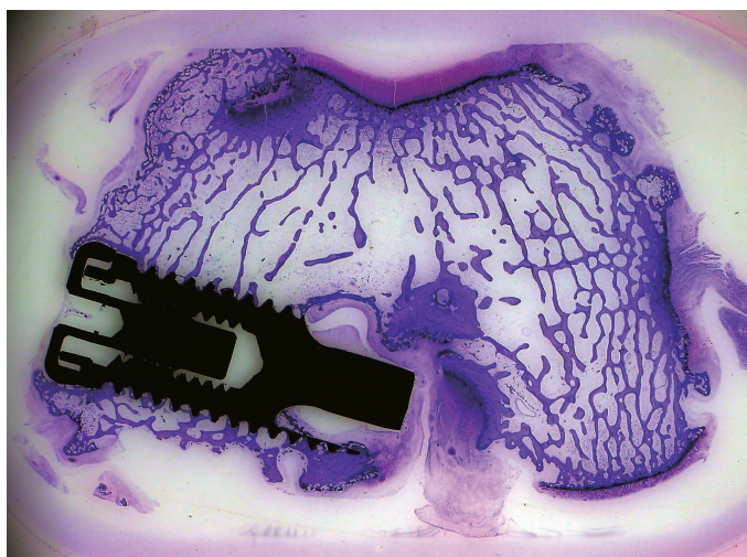
Figura 1. Implante con superficie TiO2 en fémur de conejo Nueva Zelanda. 8X
