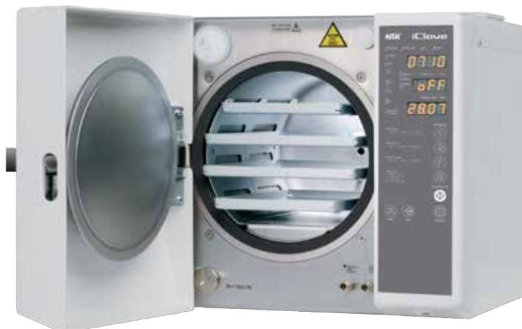
litros (volumen útil 24 ecolitros), tiene bomba de vacío fraccionado, bomba de drenaje, calor adaptativo, tres sensores de temperatura, bajo consumo energético y
